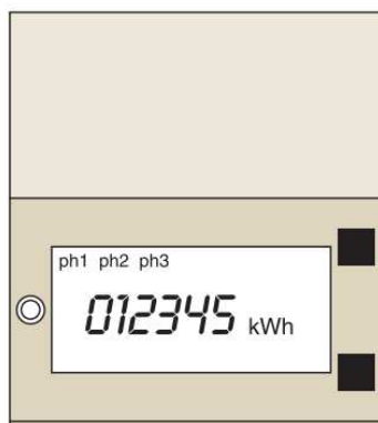
Figure 3. Exemple de lecture de la puissance instantanée sur un compteur EDF triphasé.
